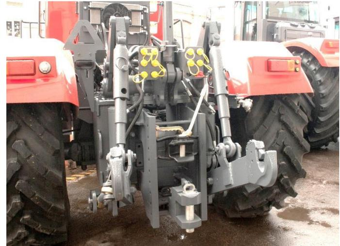
Задняя навеска с функцией позиционно-силового регулирования входит в базовую комплектацию.
