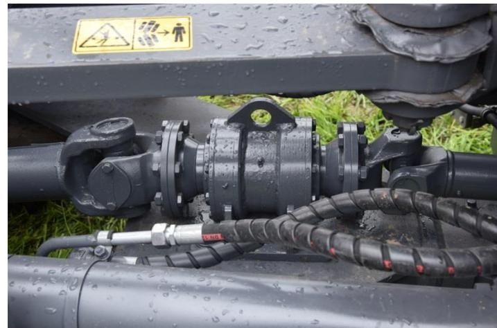
Промежуточная опора (промопора)
